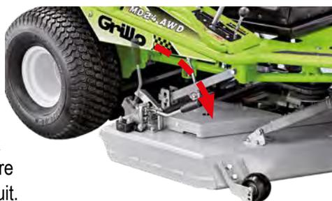
MD 22N et MD 24 AWD sont équipés avec une coupe de 110 cm, tandis que pour la MD 28 AWD de 132 cm, les deux avec un levier "Quick Shift", pour le passage rapide entre Mulching et éjection arrière directement du poste de conduit. Le châssis de tonte est complètement en acier pour un vrai usage professionnel. Les arbres porte-lames de grand diamètre et la transmission **offrent une fiabilité extraordinaire même dans les conditions les plus difficiles** et pour plusieurs heures en toute sécurité.
